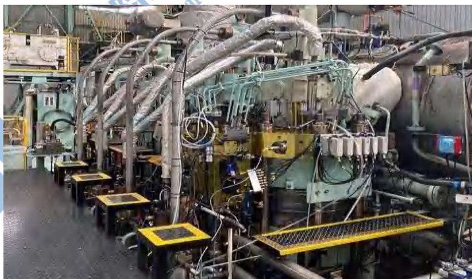
该试验用发动机为 MAN B&W 4S50ME-T，其输出功率为 7 MW，额定转速为
